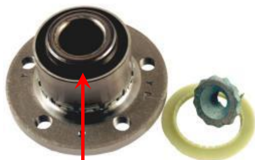
Presença de um codificador magnético
