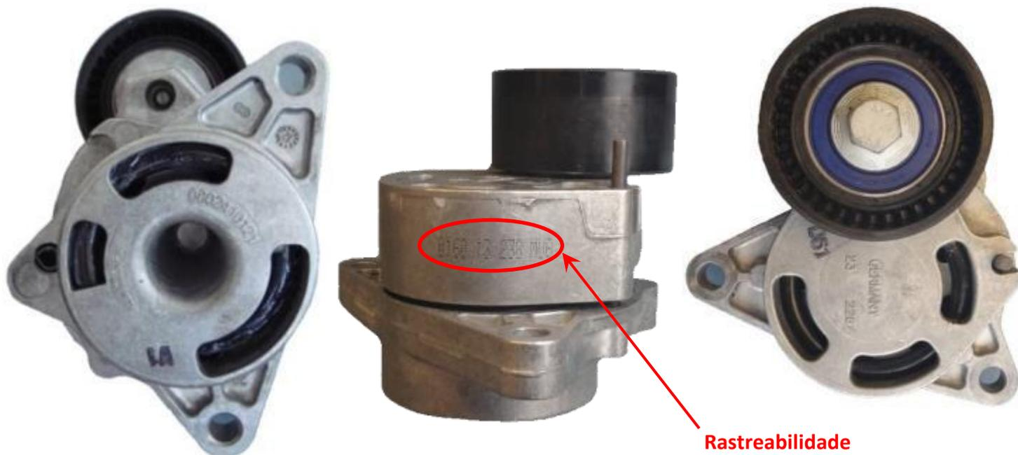
A GA355.16 não foi concebida para absorver os choques violentos provocados pela correia; assim, a correia fica mal esticada e escorrega nos rolos (**FIG 1**). A correia a escorregar provoca calor no perímetro exterior da polia do rolo tensor. Isto provoca o aumento da temperatura dentro da polia, provocando a sua falha.
