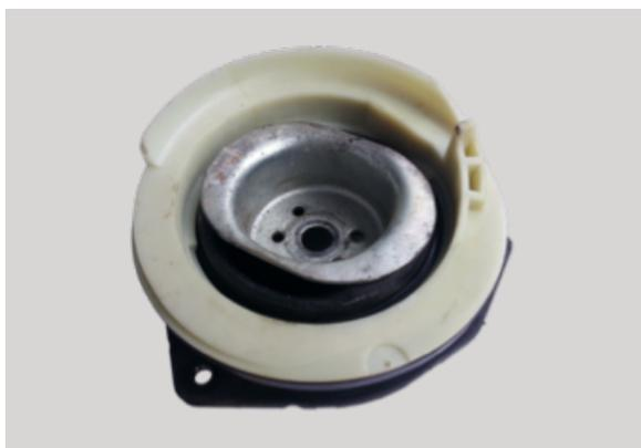
**FIXAÇÃO SUPERIOR E HASTE DO ROLAMENTO AMORTECEDOR DE MÁ QUALIDADE a perfurar o corpo do veículo**
