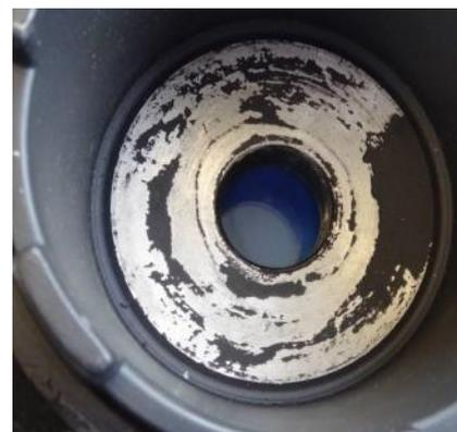
Следы сколов на передней контактной поверхности шкива указывают на неправильно затянутый стопорный винт.
