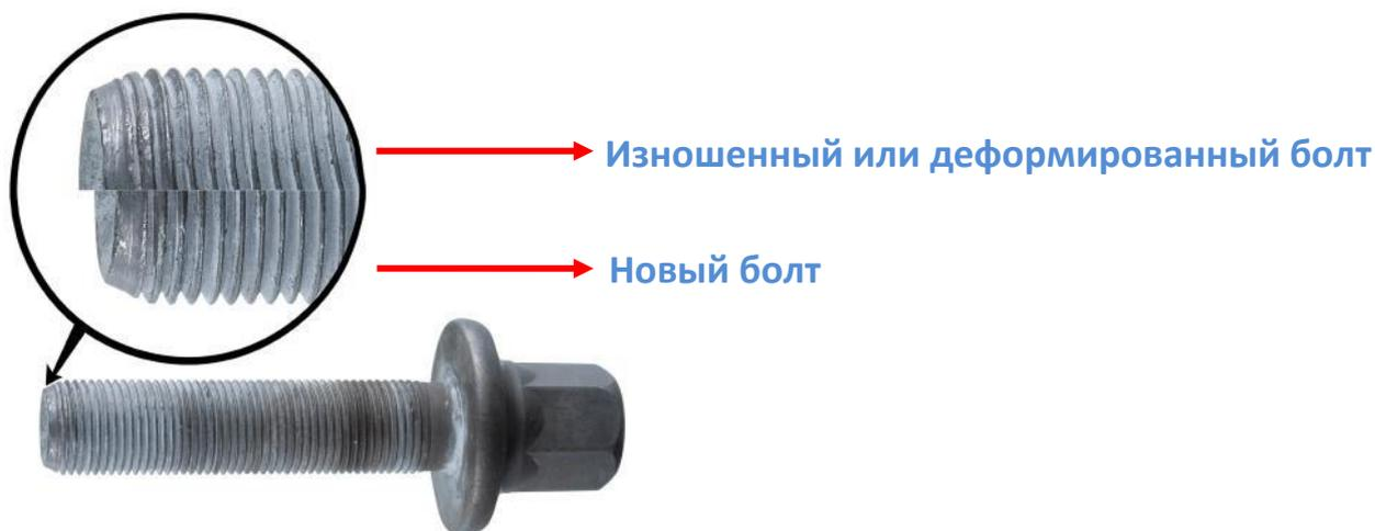
При использовании растянутого болта происходит изменение его механических свойств, и болт уже не соответствует допуску, установленному изготовителем
