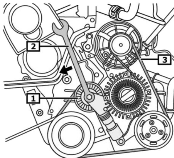
4) Установить кронштейн-фиксатор в рабочее положение
