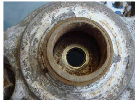
Выход из строя комплекта опоры может быть вызван попаданием влаги или грязи. Важно заменить все детали, входящие в комплект, в последовательности, рекомендованной производителем. Большинство неисправностей возникает по причине неверной последовательности монтажа (см. инструкцию по установке).
