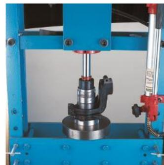
\*Диаметр трубки для запрессовки должен соответствовать поверхности, на которую действует сила пресса.
