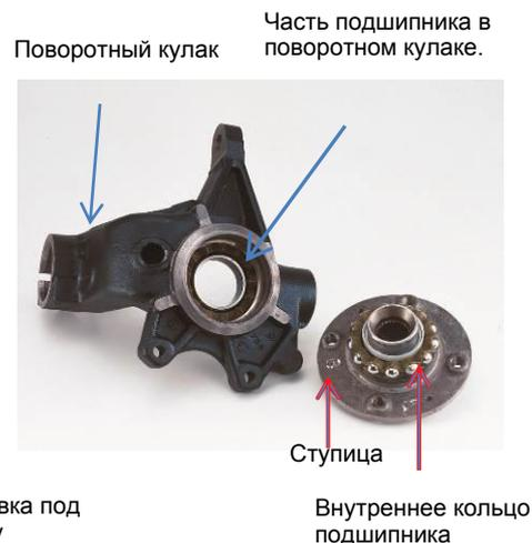
4. Если сепаратор с шариками остался на внутреннем кольце, используйте съемник для его удаления. Съемник необходимо зажать по дорожке качения. Если дорожка качения отсутствует, зажмите съемник между ступицей и подшипником.
