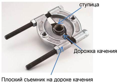
5. Установите съемник на пресс. Надавите оправкой или трубкой (см. пункт 2) на ступицу.
