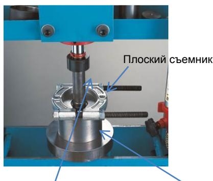
6. Для демонтажа стопорного кольца используйте съемный инструмент.
