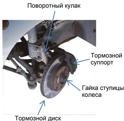
2. Установите поворотный кулак в пресс на подставку. При помощи оправки или трубки нужного диаметра выдавите ступицу из поворотного кулака.
