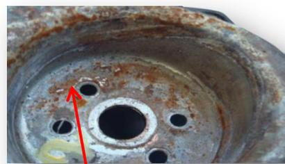
Образование коррозии из-за смещения пружины
