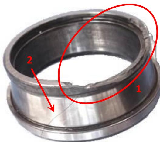
Таким образом, в рулевые дорожки могут попасть загрязнения, что вскоре приводит к образованию шума, а затем – к разрушению подшипника.
