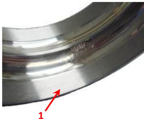
Неправильный монтаж подшипника приводит к неисправности вычислительного устройства ABS (код ошибки, световой индикатор ABS). Необходима замена на новый подшипник. При монтаже подшипника убедитесь, что магнитный кодер расположен на внутренней стороне автомобиля (со стороны датчика).
