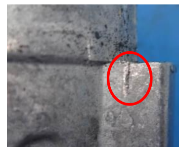
Ślady na ograniczniku rolki napinacza
