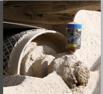
Aufgrund seiner kompakten Größe kann der Ready Booster für verschiedene Anwendungen eingesetzt werden: Wälzlager, Lagergehäuse, Kettenschmierung, Elektromotoren, Ventilatoren, Pumpen, Förderbänder usw.
