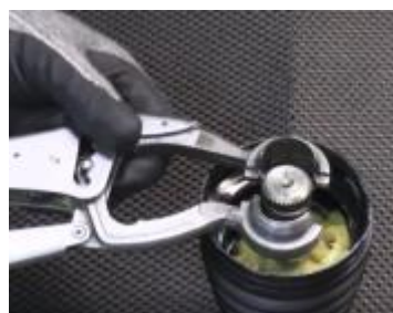
Используйте специальные клещи для того, чтобы сжать стопорное кольцо на валу.
