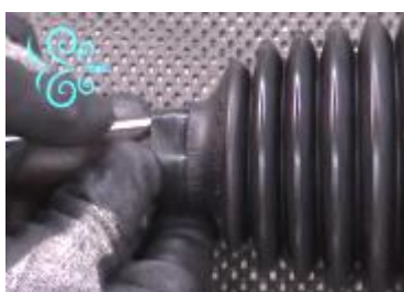
Отодвиньте пыльник отверткой, чтобы избежать сдавливания или распираания пыльника.
