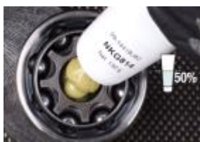
Половину смазки следует выдавить в шарнир
