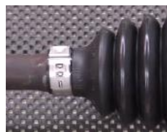
Сожмите ушко пыльника специальными клещами в соответствии с инструкцией
