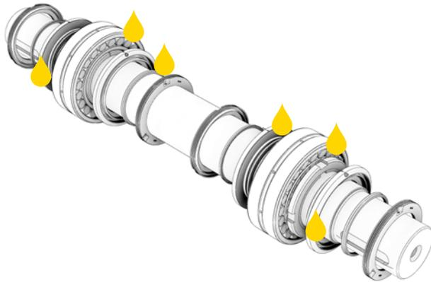
Anschließend die außen liegenden Dichtungselemente in folgender Reihenfolge auf die Welle schieben.
