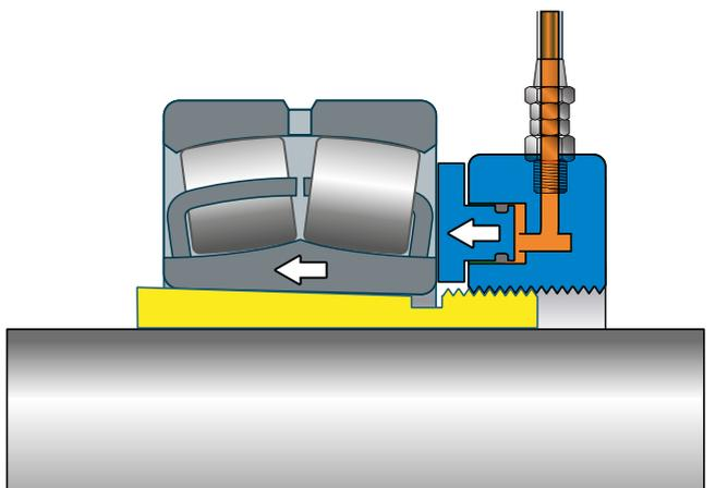
Montage eines Lager auf Spannhülse
