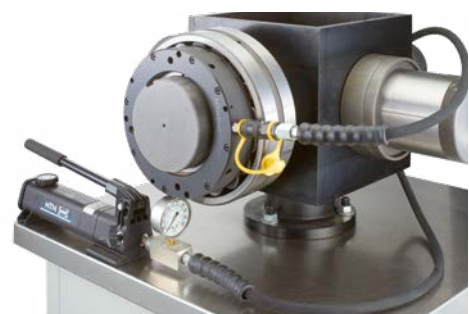
Montaje con manguito de apriete con una tuerca hidráulica.
