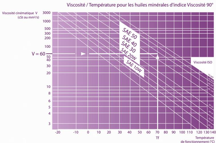
➤ Il faut ensuite calculer la viscosité du lubrifiant à choisir compte tenu de la température de fonctionnement du roulement.
