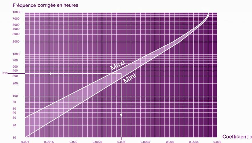
Cette fréquence corrigée permet de déterminer le poids de graisse à mettre, en fonction :
