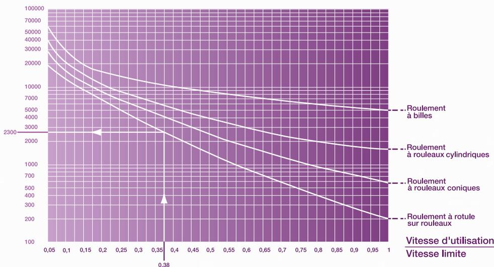
La fréquence de base ( $F_b$ ) de regraissage dépend du type de roulement et du rapport de la vitesse d'utilisation sur la vitesse limite donnée dans les caractéristiques du roulement.
