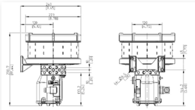
NRUN: modèle destiné aux véhicules industriels. Le raccordement avec activation générale (NRUN) permet d'utiliser la pompe avec la machine en asservissement. La pompe ne fonctionne que si le signal d'activation est présent, sinon elle reste en mode veille ; le signal d'activation externe est un signal logique standard +5 V.
