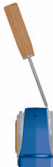
Desmontagem das tampas de proteção
