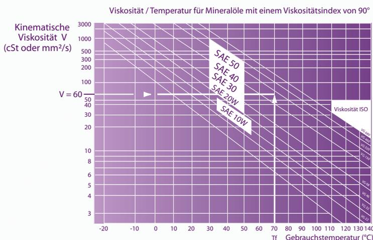
► Anschließend muss die Viskosität des Schmiermittels berechnet werden, das unter Berücksichtigung der Gebrauchstemperatur des Lagers gewählt werden muss.
