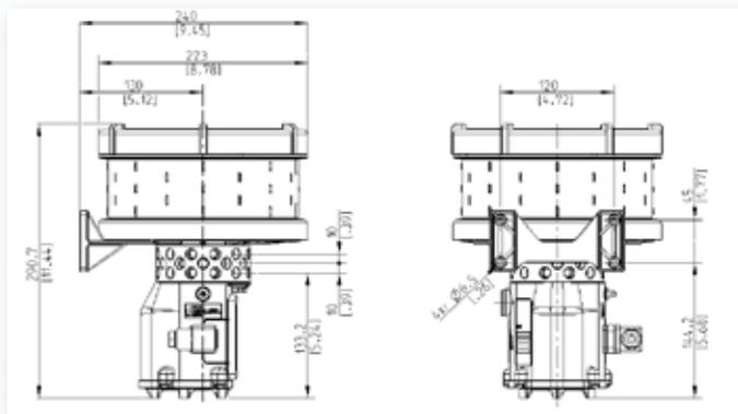
NRUN: Modell für Industriefahrzeuge. Der Anschluss für allgemeine Aktivierung (NRUN) ermöglicht die Verwendung der Pumpe mit Ansteuerung über die Maschine. Die Pumpe arbeitet nur, wenn das Aktivierungssignal anliegt, ansonsten verbleibt sie im Bereitschaftszustand. Das externe Aktivierungssignal ist ein Logik-Standardsignal +5V.
