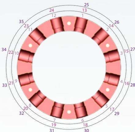
Schrauben Sie die Pumpelemente (SW12) und die Verschlüsse (SW6) mit einem Anzugsmoment von 10 Nm fest.
