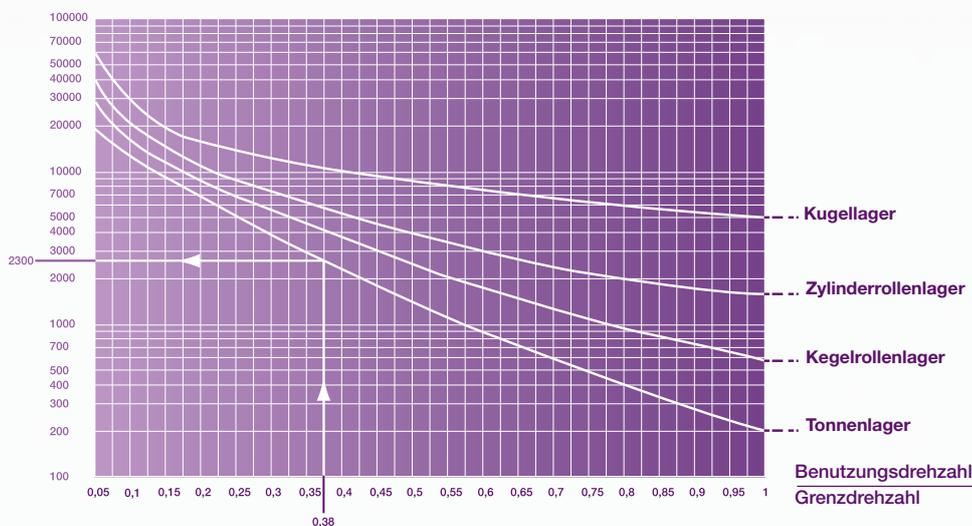
Das Grundintervall ( $F_b$ ) der Neuschmierung hängt vom Lagertyp und vom Verhältnis zwischen der Benutzungsdrehzahl und der Grenzdrehzahl gemäß den Lagereigenschaften ab.
