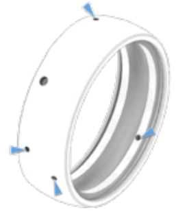
G2 Sistemi: İki düzlemde dört yağlama deliğine sahip dış bilezik
