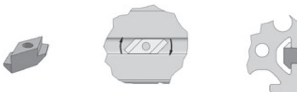
Figure 6.3\_\_\_ Conceptions d'écrous de rainure
