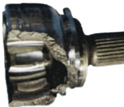
Pęknięcie korpusu przegubu
