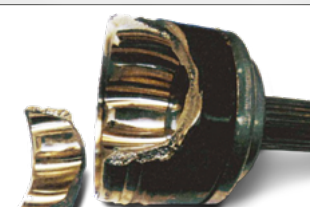
Pęknięcie korpusu przegubu
