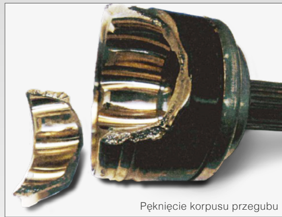
Pęknięcie korpusu przegubu
