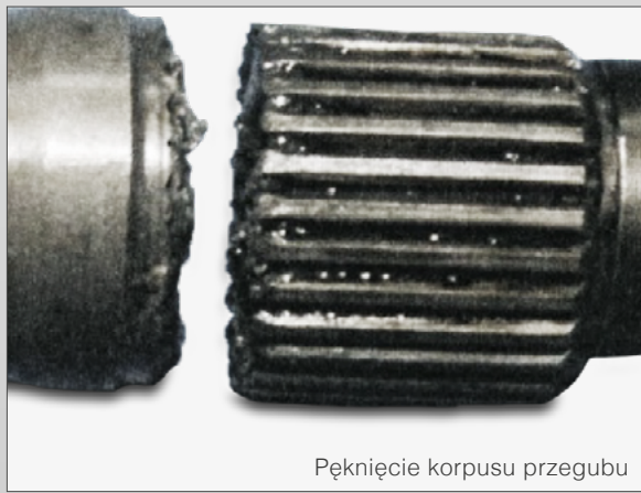
Pęknięcie korpusu przegubu
