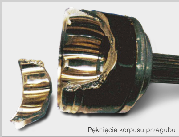
Pęknięcie korpusu przegubu
