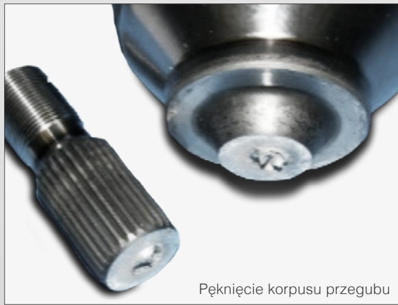
Pęknięcie korpusu przegubu
