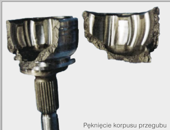
Pęknięcie korpusu przegubu
