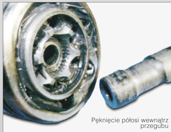
Pęknięcie półosi wewnątrz przegubu
