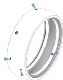
Sistema G2: anello esterno dotato di quattro fori di lubrificazione su due piani
