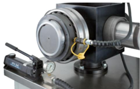
Montage auf Abziehhülse durch Umdrehen der Hydraulikmutter
