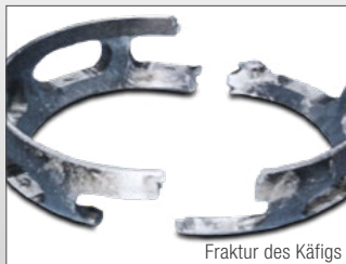
Bruch von Verbindungselementen im Inneren des Gelenks
