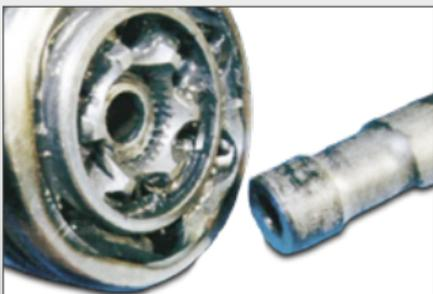
Rupture éléments de liaison interne au joint
