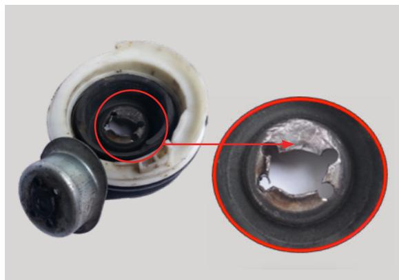
Einige Hersteller kopieren die **Formen und Farben** der Teile, damit sie für ein dem Originalteil gleichwertiges Teil gehalten werden. Aber da die Originaleigenschaften nicht beachtet werden (Wärmebehandlung, Metallverstärkungen...), kann der Einsatz dieser Produkte zur Folge haben, dass die Karosserie bei einem Schlag durchstoßen wird.
