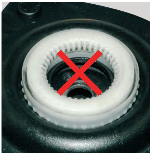
NIEPOPRAWNY MONTAŻ OGRANICZONA SPRAWNOŚĆ UKŁADU KIEROWNICZEGO
