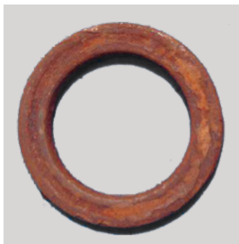
ŁOŻYSKO ZAWIESZENIA SKORODOWANE NA SKUTEK WNIKANIA ZANIECZYSZCZEŃ
