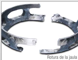
Rotura elementos de conexión interna a la junta
