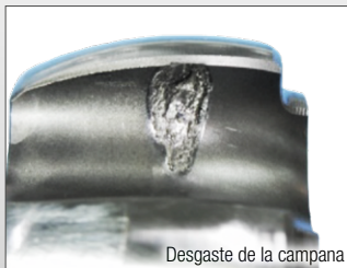
Rotura de la campana
