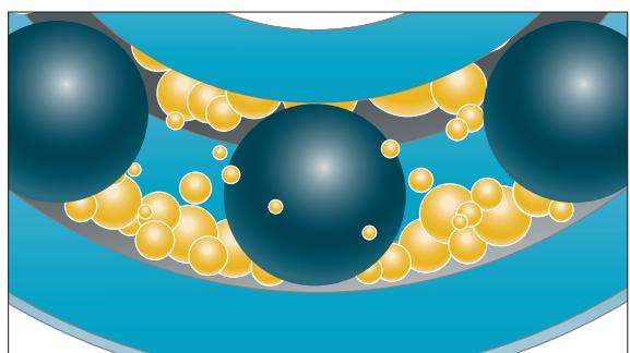
Katı yağ dışarı atılamaz, böylece rulmanın sürekli olarak yağlanması sağlanır. Bu da tüm üretim kesintileri ve yeniden yağlama işlemlerinin ortadan kaldırılmasını sağlar (oynak yataklı rulman üniteleri için)
