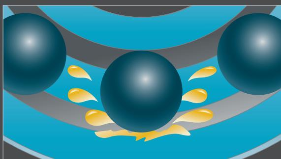
Mekanik ve termal stresse bağlı olarak, gres tabaka haline gelerek yuvarlanma elemanı ve yuvarlanma yolu arasındaki temas yüzeyinden dışarı çıkar. Bu kayip nedeniyle, sıklıkla yeniden yağlama yapılması gereklidir (oynak yataklı rulman üniteleri için)
