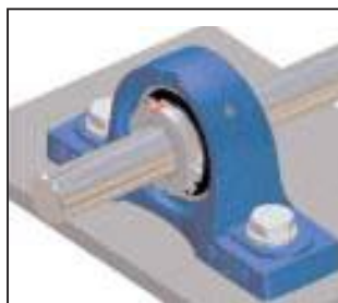
5. Bloquer le manchon de serrage (plier une languette de la rondelle-frein dans une rainure de l'écrou à encoches).
