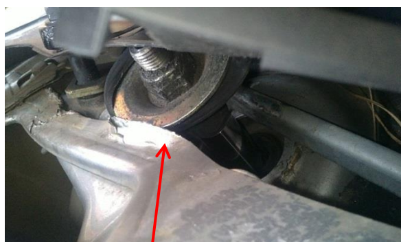
Опора поганої якості Шток амортизатора проникає через кузов автомобіля
