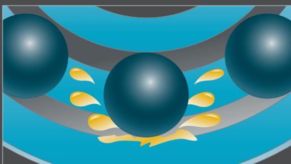
В результате механических и термических нагрузок смазка расслаивается и вытекает с поверхности контакта тела качения и беговой дорожки. Из-за этого требуется часто вносить новую порцию смазки (в самоустанавливающихся подшипниковых узлах).
