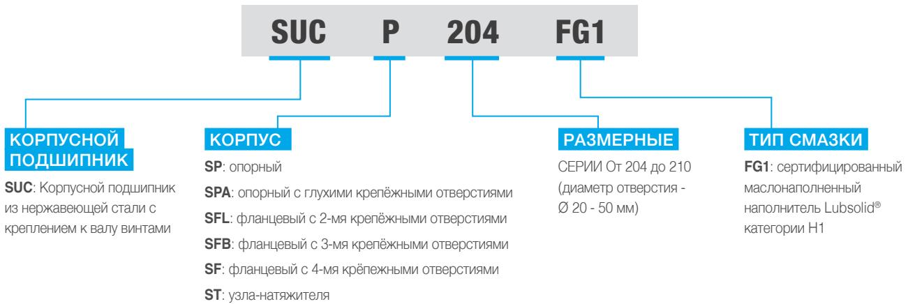
**SUC:** Корпусной подшипник из нержавеющей стали с креплением к валу винтами
