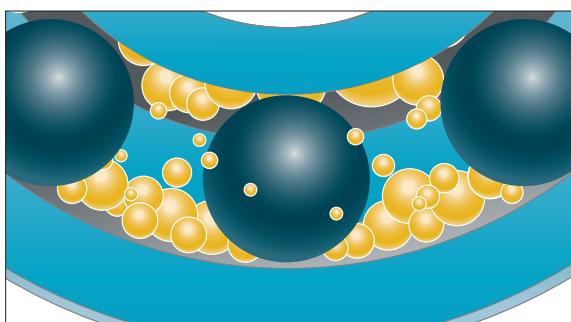
Твёрдый полимерный маслосодержащий наполнитель остаётся в подшипнике и обеспечивает его постоянное смазывание. Это позволяет исключить простоя и операции пересмазывания (например, в самоустанавливающихся подшипниковых узлах).
