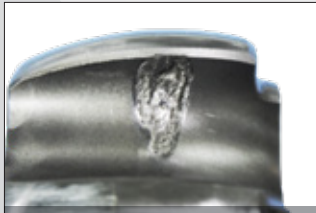
Abplatzungen an der Kugelnabe
