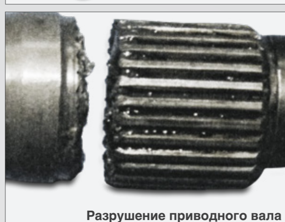
Разрушение приводного вала
