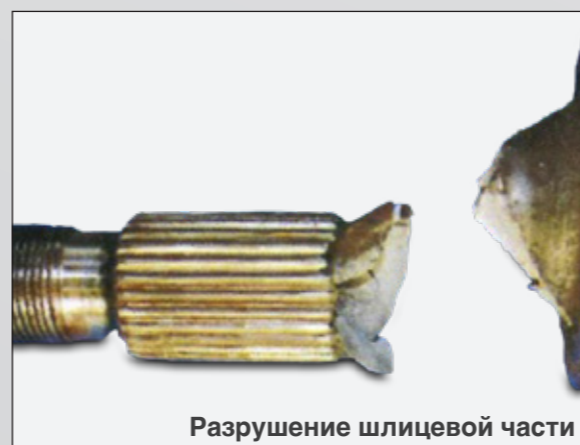
Разрушение шлицевой части
