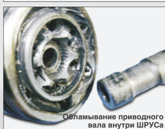
Обламывание приводного вала внутри ШРУСа
