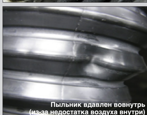
Пыльник вдавлен вовнутрь (из-за недостатка воздуха внутри)
