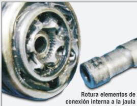
Rotura elementos de conexión interna a la jaula
