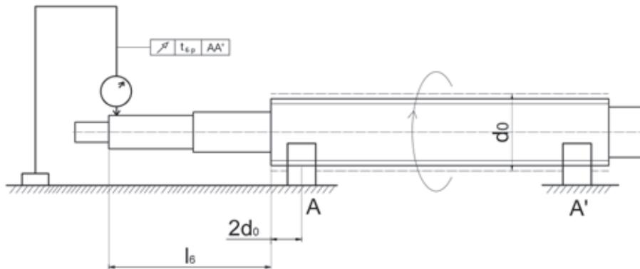
Bild 2.3 \_\_\_\_ Messung der Rundlaufabweichung  $t_{6,1}$  des Lagersitzes
