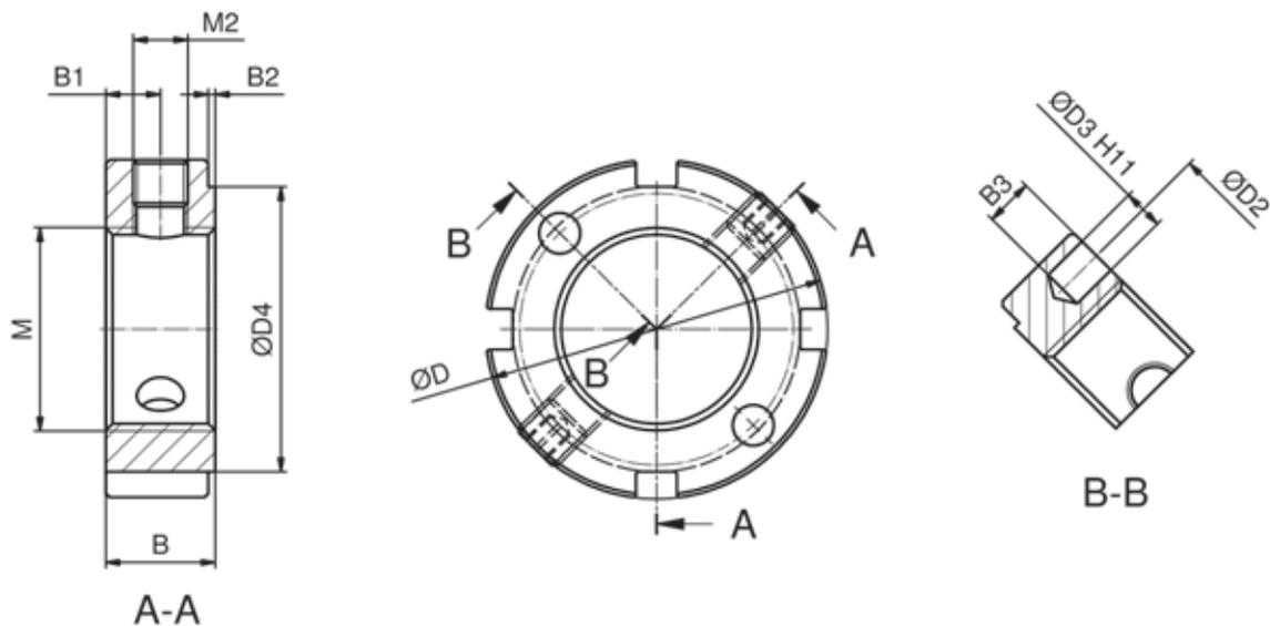
Bild 6.8 \_\_\_\_\_ Abmessungen Präzisionsmuttern PRS
