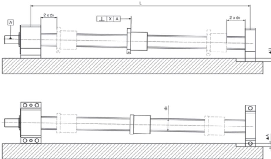
Bild 3.4 \_\_\_\_\_ Definition der Montagetoleranzen von Kugelgewindetrieiben
