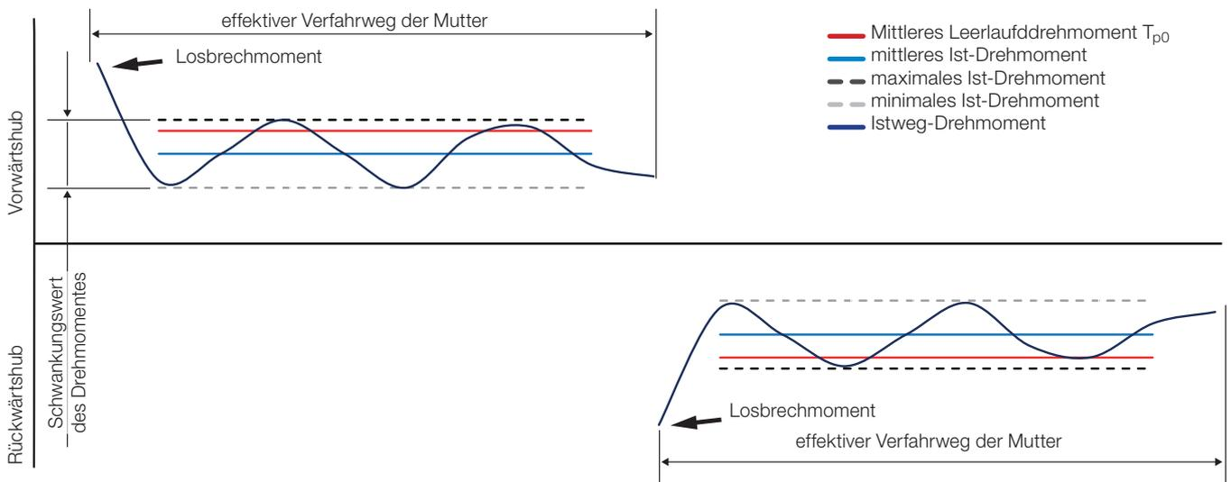
Bild 2.11 \_\_\_\_ Leerlaufdrehmomentschwankung von Kugelgewindetriebs
