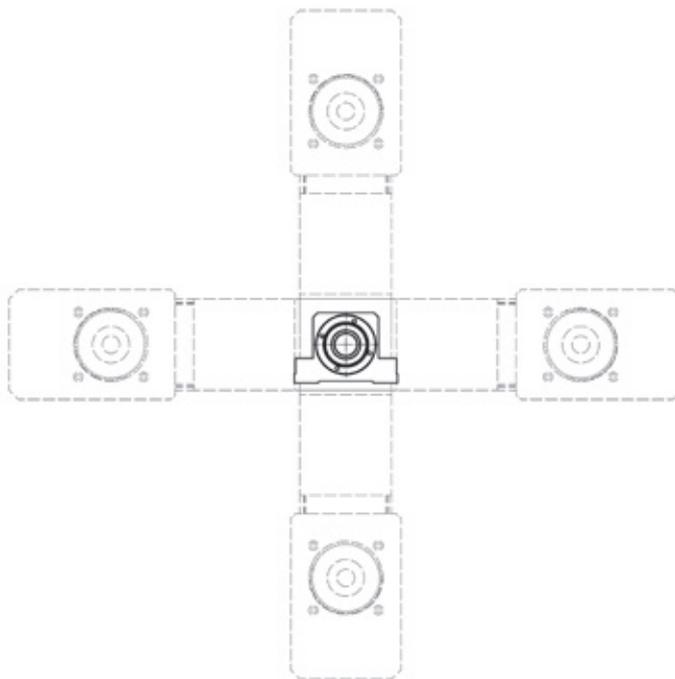
Bild 6.25 \_\_\_\_ Anordnung Standardumlenkriementriebe für BSTK - Lagerungen
