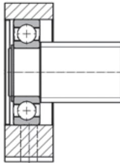
Bild 6.8 \_\_\_\_\_ Loslagereinheit BSTF
