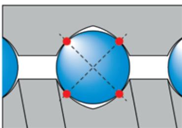
Bild 1.2 \_\_\_\_\_ Gotikbogengeometrie
