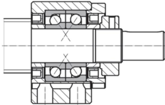
Bild 6.9 \_\_\_\_\_ Lageranordnung DF in Festlagereinheiten BK und EK
