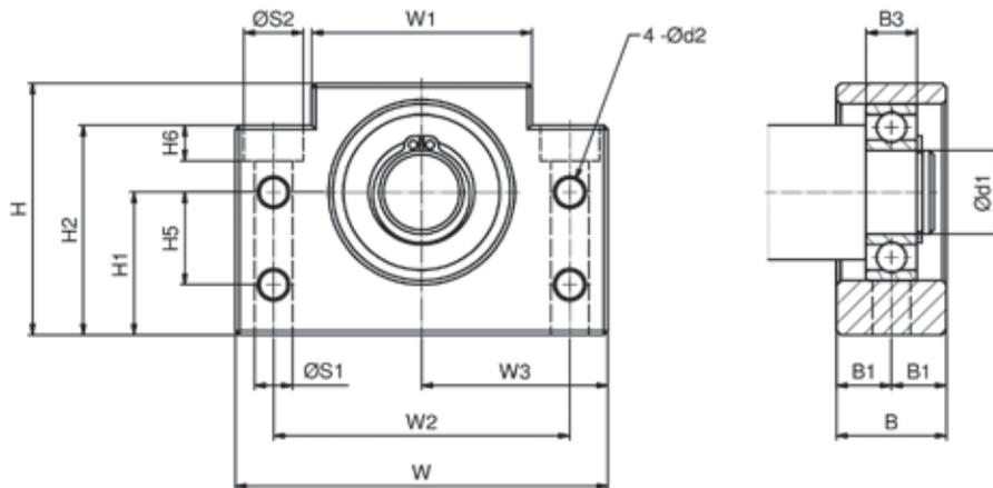
Bild 6.14 \_\_\_\_ Abmessungen Loslagereinheiten BF und EF
