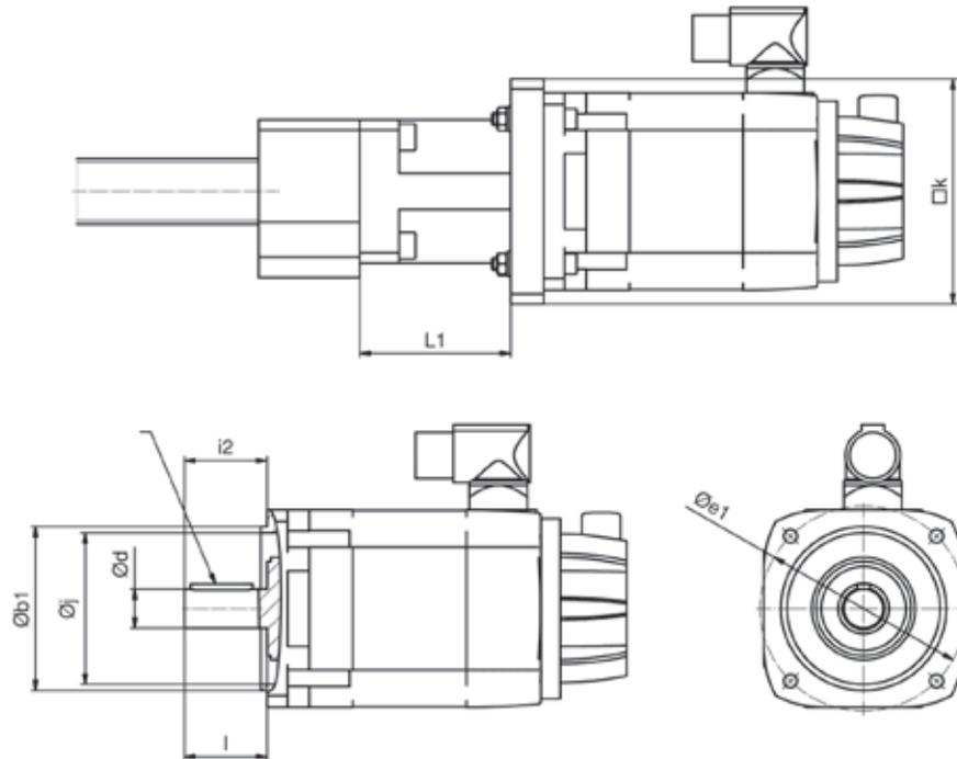
Bild 6.23 \_\_\_\_ Abmessungen Standardkupplungsglocken für BSTK - Lagerungen
