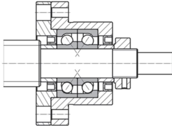
Bild 6.11 \_\_\_\_ Lageranordnung DF in Festlagereinheiten FK
