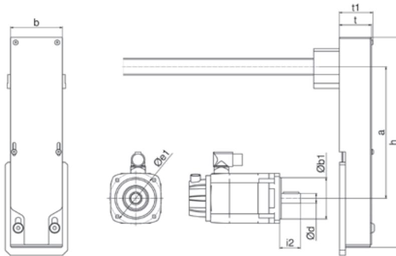
Bild 6.24 \_\_\_\_ Abmessungen Standardumlenkriementriebe für BSTK - Lagerungen
