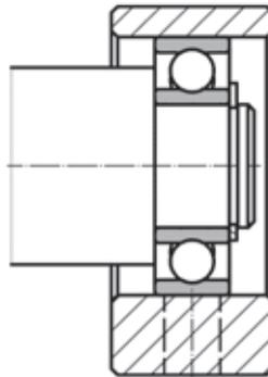
Bild 6.13 \_\_\_\_ Loslagereinheiten BF und EF
