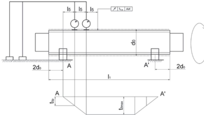
Bild 2.2 \_\_\_\_ Messung der Rundlaufabweichung  $t_5$  des Kugelgewindespindelaußendurchmessers
