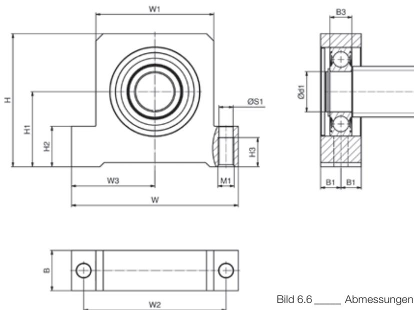
Bild 6.6 \_\_\_\_\_ Abmessungen Loslagereinheiten BSTF
