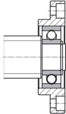
Bild 6.18 \_\_\_\_ Loslagereinheiten FF
