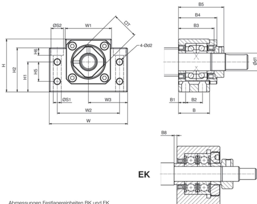
Bild 6.10 \_\_\_\_\_ Abmessungen Festlagereinheiten BK und EK
