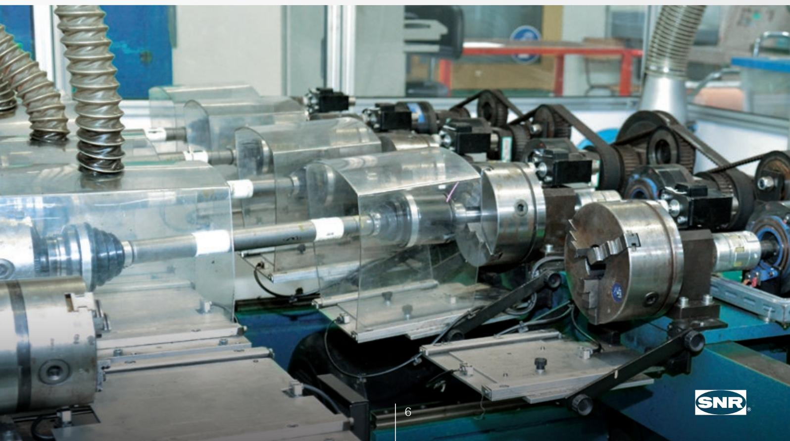
Des essais négligés mettent en danger les automobilistes, il peut y avoir une perte de motricité, une rupture de la tulipe qui peut entraîner une perte de la roue en conduisant.
