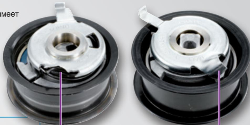
Нижний упор сломан или имеет следы касания
