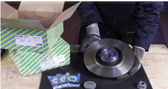
4. per i mozzi dischi freno con tecnologia ASB®, togliere la protezione poco prima del montaggio. Non segnare il codificatore. Non avvicinarlo ad una superficie sporca e/o magnetica. Controllare l'uniformità dei poli magnetici del codificatore con la scheda test ASB®.
