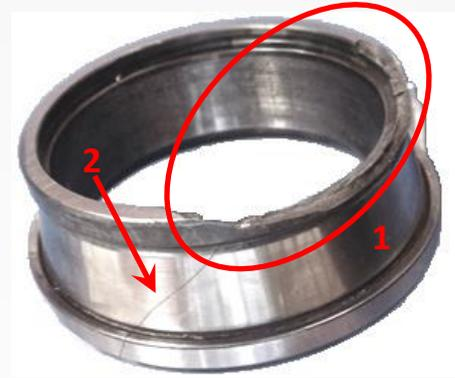
Des éléments peuvent alors passer dans les pistes du roulement, ce qui entraîne rapidement du bruit, puis conduit à la destruction du roulement.
