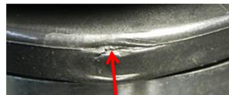
Чрезмерная затяжка приводит к повреждению пыльника.
