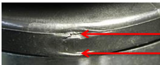
Порезы на пыльнике, вызванные чрезмерным усилием затяжки хомута
