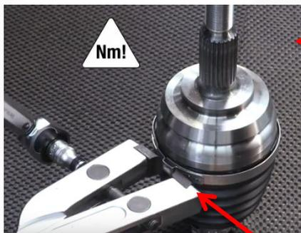
**Шаг 2 :** Строго соблюдайте момент затяжки, установленный для данного диаметра и/или ширины хомута.
