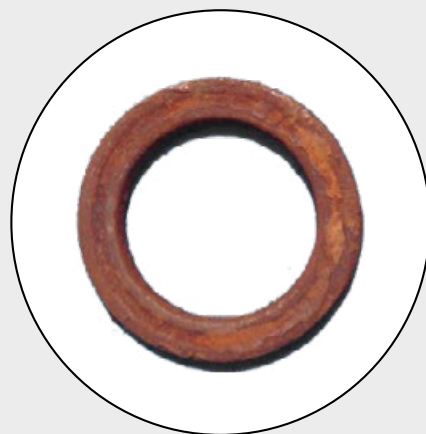
Łożysko zawieszenia skorodowane na skutek wnikania zanieczyszczeń
