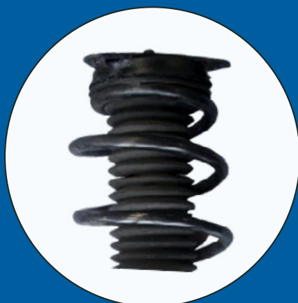
Zniszczona poduszka zawieszenia
