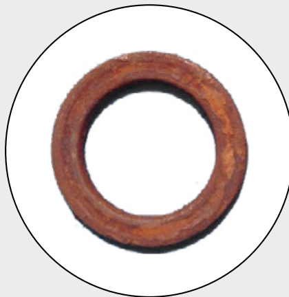
Коррозия опорного подшипника вследствие воздействия загрязнителей
