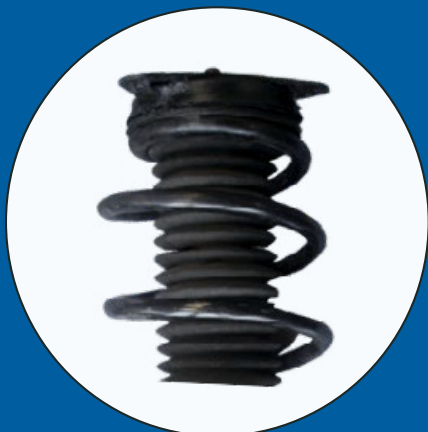
Износ упругого элемента
