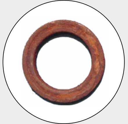
Kır girişi nedeniyle korozyona uğramış amortisör rulmanı
