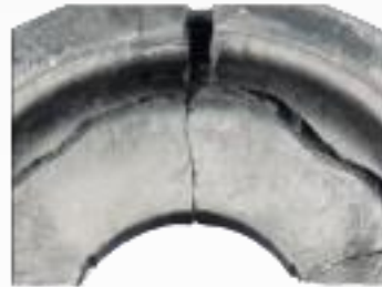
Defektes Dämpferlager: Federteller gerissen
