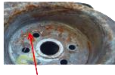
Durch Bewegung der Feder verursachte Korrosion
