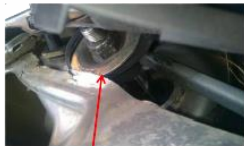
Federbeinlager und Stützlager in minderwertiger Qualität Kolbenstange durchstößt die Karosserie
