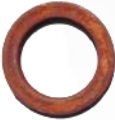
Verschlissener Dichtring Dämpferlager durch eindringende Verschmutzungen korrodiert
