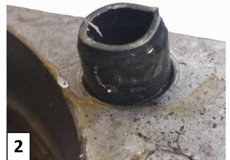
Eine defekte Generatorfreilaufriemenscheibe lässt sich auch daran erkennen, dass am Spannrollenanschlag Schlagspuren zu sehen sind und dieser verformt ist. Dieser Defekt wird durch eine sehr starke Ausschlagbewegung der Spannrolle verursacht (Abb. 2).
