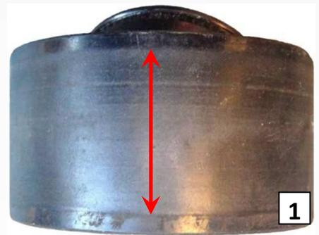
GA355.16 ist nicht darauf ausgelegt, starke Schwingungen des Riemens zu absorbieren, wodurch die Spannfunktion leidet und der Riemen auf der Rolle durchrutschen kann (Abb. 1). Die Reibungswärme des Riemens überträgt sich auf den Außendurchmesser der Spannrolle. Dadurch steigt die Innentemperatur der Spannrolle an, sodass diese beschädigt wird.
