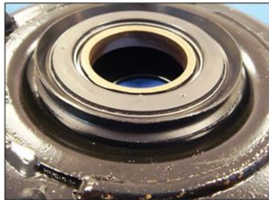
Lage der Dichtung auf dem Federbeinlager
